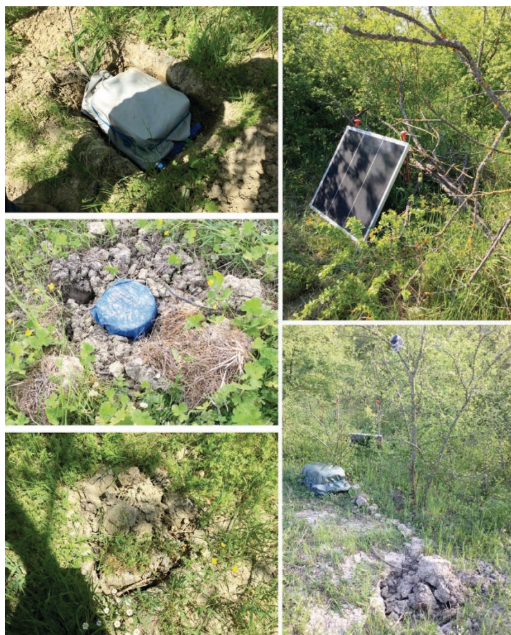
Figura 5. Alcuni particolari delle stazioni installate durante l'esperimento sismico alle Salse di Nirano.
