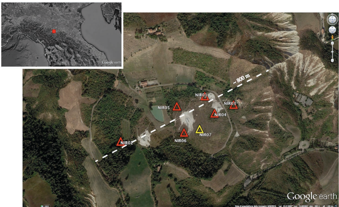
Figura 4. Mappa della rete sismica temporanea installata presso le Salse di Nirano tra marzo e giugno del 2016. La rete era costituita da 7 stazioni di cui 6 (triangoli rossi) equipaggiate con velocimetro Lennartz LE 3D/5s e una (triangolo giallo) con sensore a larga banda Trillium 120c. La rete copre un'area molto piccola di circa 500 x 180 m.
